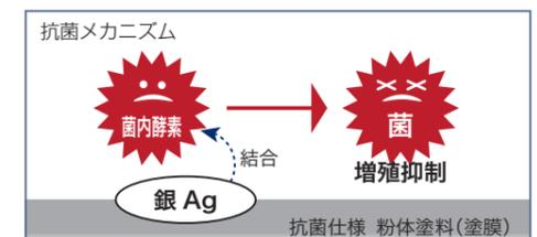
塗膜中の銀が手に付着している大腸菌などの菌内の酵素(たんぱく質)と結合し、代謝機能を抑え、菌の増殖を抑制します。
