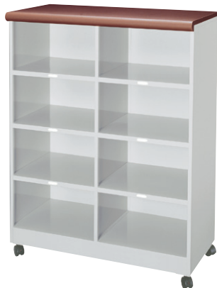
● FR2-4NSF / キャスター付収納棚 H1275×W978×D450 (h246×w462) 天板ポストフォーム貼、横仕切板差込構造(補強付)、 底板(補強付)、各部溶接補強、キャスター付
