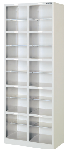
◆ ST2-5N / オープンシューズケース(2列5段10人用) H1453×W538×D350 (h253×w242) 横中仕切板差込構造、 名札差プレス加工、中棚付
