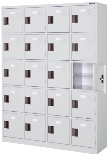
◆ ST4-5 / シューズケース(4列5段20人用) H1453×W1058×D350 (h258.6×w242) 横中仕切板差込構造、 名札差プレス加工、中棚付
