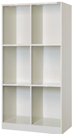
TF2-3N (2列3段 6人用) H1790×W900×D510 横仕切板差込構造(補強付)、底板(補強付)、 各部溶接補強、巾木一体、 名札差プレス加工
