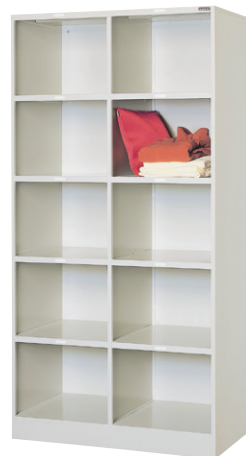
TF2-5N (2列5段 10人用) H1790×W900×D510 横仕切板差込構造(補強付)、底板(補強付)、 各部溶接補強、巾木一体、 名札差プレス加工
