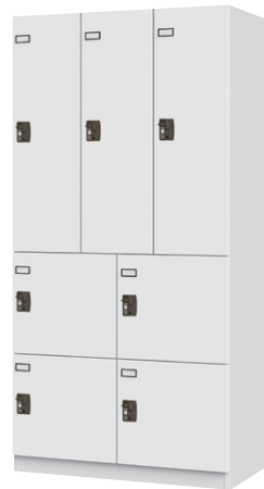
YSL3-2-2C (上段3列 下段2列2段 7人用) H1800×W900×D515 丁番：スライドヒンジ 横中仕切板溶接固定、扉(補強付) 上段扉寸：H925×W292 ハンガーパイプ、Sフック[3] 付 下段扉寸：H395×W442
