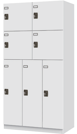
YSL2-2-3C (上段2列2段 下段3列 7人用) H1800×W900×D515 丁番：スライドヒンジ 横中仕切板溶接固定、扉(補強付) 上段扉寸：H395×W442 下段扉寸：H925×W292 ハンガーパイプ、Sフック[3] 付
